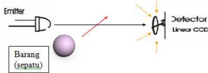
■ Gambar 2. Cara Kerja Sensor Inframerah
