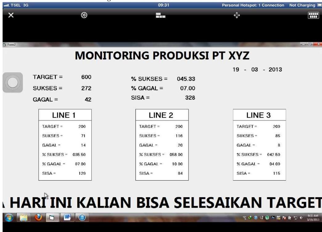
■ **Gambar 4.13** Tampilan LCD Monitor Tempat Pekerja pada *Software "iTeleport"*
