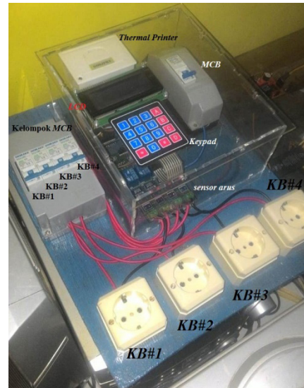
Gambar 7. Bentuk fisis sistem terintegrasi berbasis mikrokontroler Arduino MEGA2560 R3 untuk pemantauan energi listrik pada satu kWh-meter fase tunggal guna pengelolaan empat kelompok beban
