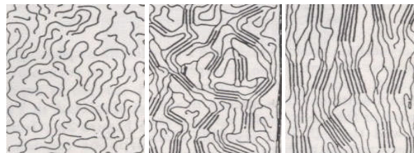
Gambar 3. Bentuk polimer amorf, kristalin dan kristalin terorientasi [5].
