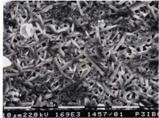
Gambar 5. Strukturmikro \text{BaO} \cdot 6\text{Fe}_2\text{O}_3 dengan aditif \text{Bi}_2\text{O}_3 hasil pengamatan SEM, setelah proses sintering pada suhu 1000°C selama 15 jam.
