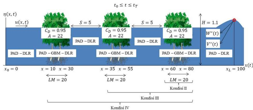
Gambar 6 Ilustrasi nilai masukan  $H = 1.1$ ,  $LM = 20$ ,  $A = 22$  dan  $C_D = 0.95$ , untuk kondisi II, III, dan IV
