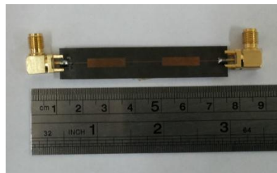
■ Gambar 10. Prototipe dari LPF dengan L = 0,3 dB
