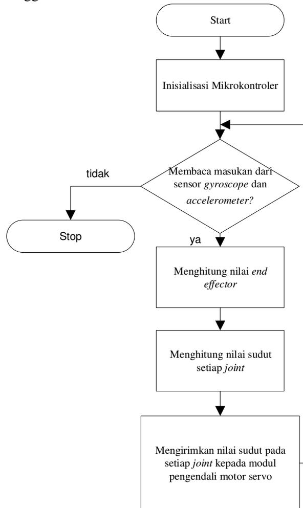
Gambar 12 Diagram alir modul pengendali gerakan kaki robot
