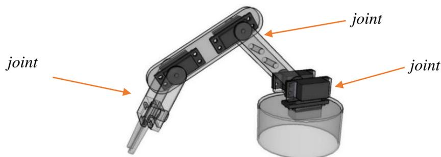
Gambar 1 Robot tangan dengan tiga derajat kebebasan [3]
