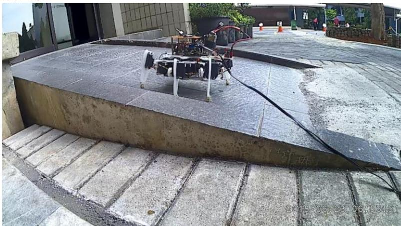
Gambar 15 Keseimbangan badan robot ketika berjalan di permukaan miring
