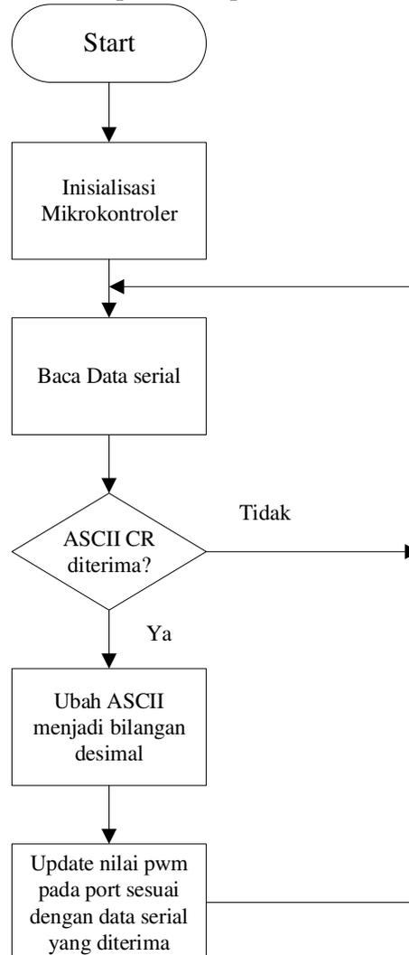
Gambar 8 Diagram alir modul pengendali motor servo
