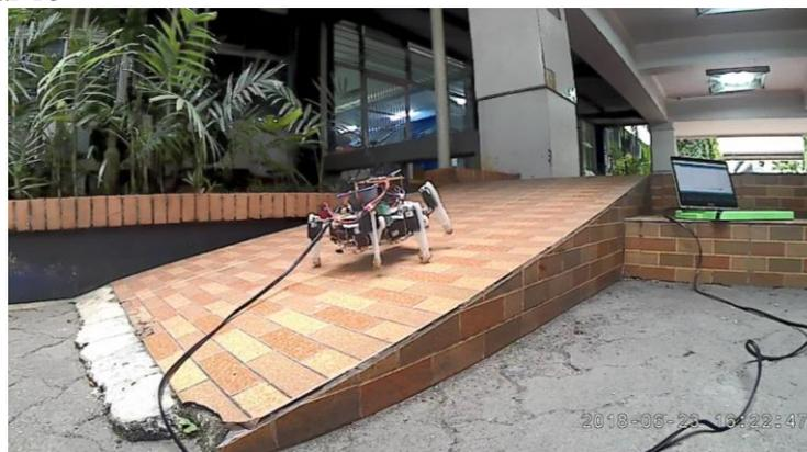
Gambar 18 Keseimbangan badan robot ketika berjalan di permukaan miring
