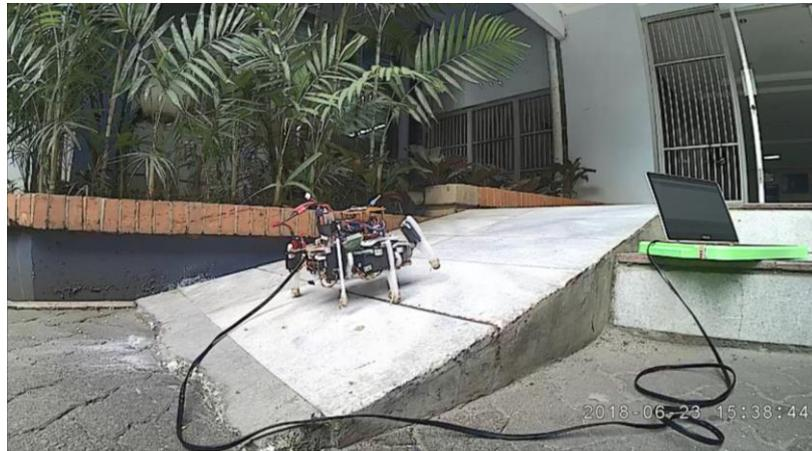
Gambar 17 Keseimbangan badan robot ketika berjalan di permukaan miring
