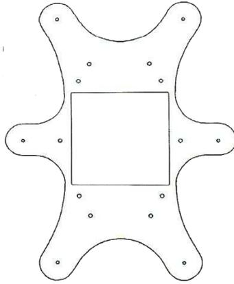
Gambar 3 Bentuk *baseplate* badan skala 1: 2,3 cm
