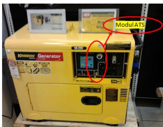
■ Gambar 1. Generator Set Berbahan Bakar Solar dengan Fasilitas ATS
