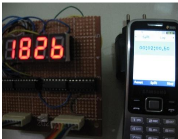
■ Gambar 10. Hasil Pengujian RTC DS1307 Setelah Dua Menit
