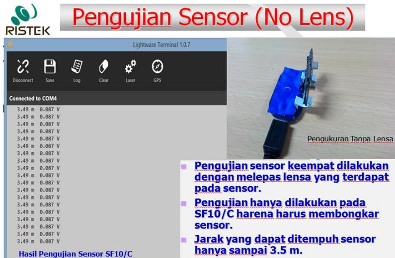
■ **Gambar 17.** Hasil Pengujian SF10/C dan SF30/C (tanpa lensa)
