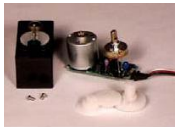
■ Gambar 9. Sistem Mekanik Motor Servo [6]
