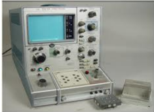
■ Gambar 7. Curve Tracer Tipe 576 Tektronix
