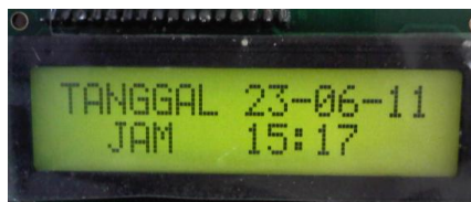
■ Gambar 11. Hasil Pengujian Modul RTC
