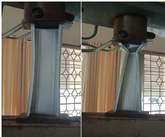
Gambar 3. Kondisi Kegagalan Pada Penampang Single Channel
