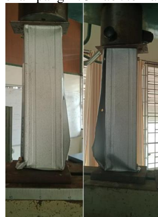
Gambar 5. Kondisi Kegagalan Pada Penampang D.C Box
