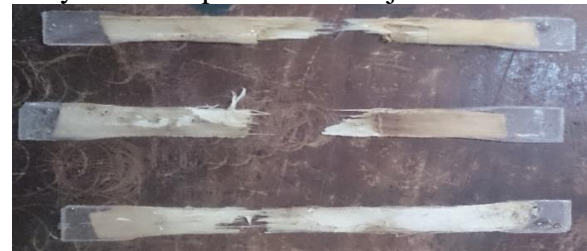
Gambar 9 Mekanisme Patahan Spesimen Uji Tarik
