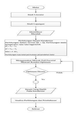
Metode yang digunakan dalam optimasi desain kondensor tipe shell and Tube ini adalah dengan memperhatikan dan menggunakan dari faktor desain awal kondensor tipe shell and Tube pada mesin sistem Air conditioner atau pendingin ruangan, dalam penelitian ini akan menggunakan metode eksperimen full Factorial dapat dibuat dalam bentuk tabel, selanjutnya dikombinasi dengan empat variabel bebas dan ada tiga level penelitian tersebut.
