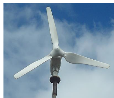
Gambar 3.4 HAWT 300 W sudu 3 [Sumber : Data Pengujian]
