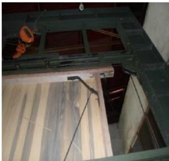
(d) Buckling pada Corner Plate Gambar 9. Hasil pengujian monotonik panel kayu tipe II
