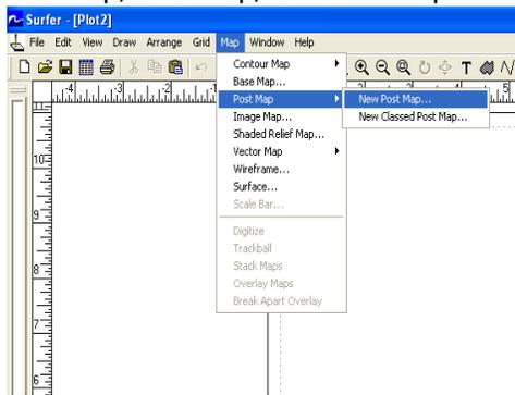
Gambar 3.23 Pilihan untuk menampilkan titik-titik polygon pengukuran
