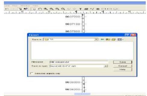
Gambar 3.26 Untuk transfer gambar dari Program Surfer 8 ke AutoCAD
