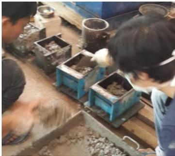
**Gambar 1.** Pencetakan benda uji
