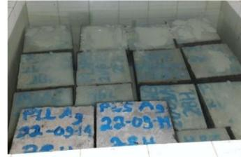
**Gambar 2.** Perawatan beton pada air garam
