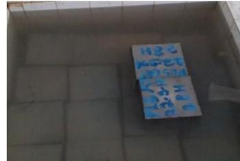
**Gambar 3.** Perawatan beton pada air tawar
