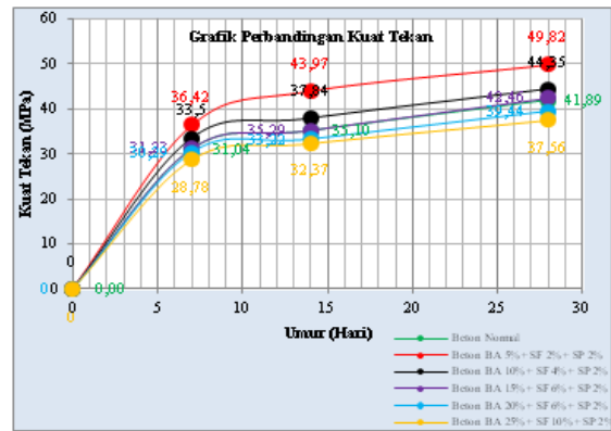
Gambar 4. Grafik Perbandingan Kuat Tekan Semua Variasi Bottom Ash dengan Tambahan Variasi Silica Fume dan Superplasticizer
