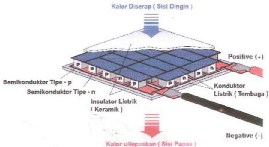
**Gambar 2.1.** Struktur Pendingin *Thermoelectric* [5]
