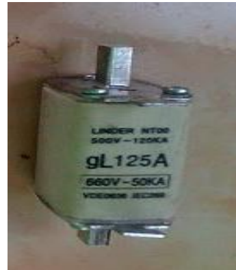
Gambar 5. NH Fuse Kondisi Baik
