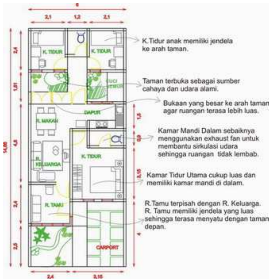
Gambar 2. Peletakan ruangan berdasarkan kondisi site
