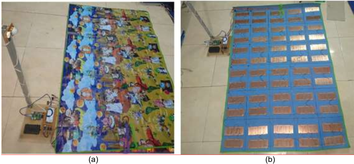
Gambar 2. Hasil perancangan sistem dan karpet tampak atas (a) dan bawah (b).
