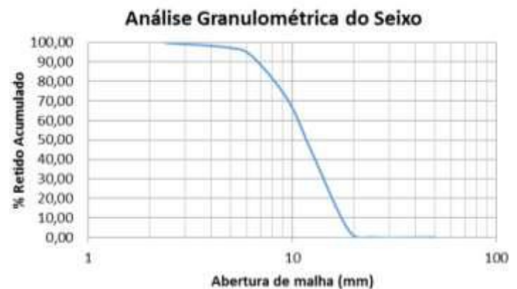
Fig.5: Gráfico da granulometria do agregado graúdo.
