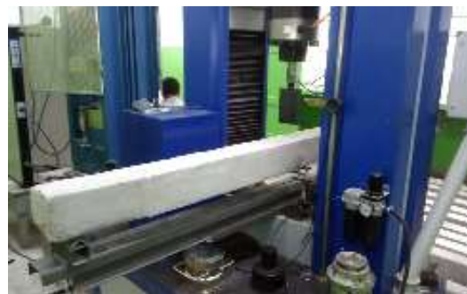
Fig.6: Ensaio de determinação das flechas nas vigotas.
