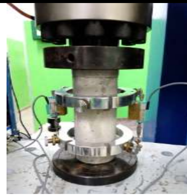
Fig.5: Corpo de prova com compressômetro utilizado para determinação do módulo de elasticidade.
