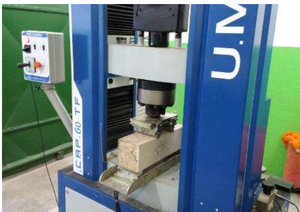
Fig.4: Máquina Universal de Ensaios/Ensaio de Resistência à tração na flexão.
