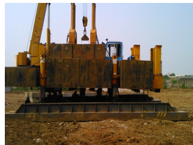
Gambar 2. Beban pada counterweigh beam
