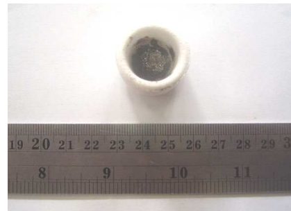
Gambar 2. Crucible yang digunakan untuk proses metalisasi
