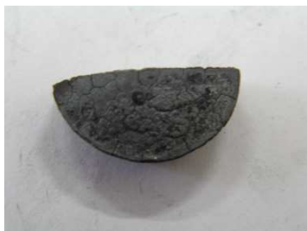
Gambar 8. Metalisasi pasir besi grafit dengan suhu 1400 °C.
