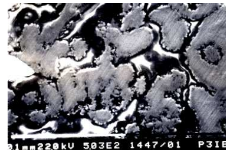
Gambar 4. Foto SEM TiAl sinter 1200 °C komposisi B (1skala 0,1mm).
