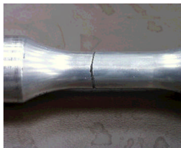
Gambar 10. Patahan akhir pada pembebanan tarik-tekan hasil percobaan.
