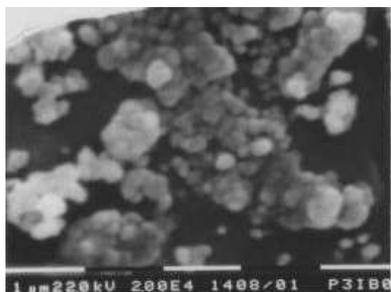
Gambar 2. Foto *SEM* dari partikel magnetik  $\text{Fe}_3\text{O}_4$  dengan perbesaran 20.000 X.
