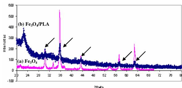
Gambar 6. Pola difraksi sinar X (a) partikel  $\text{Fe}_3\text{O}_4$  tanpa pelapis dan (b) partikel  $\text{Fe}_3\text{O}_4$  berlapis PLA
