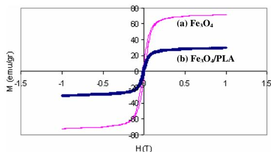
Gambar 7. Kurva histeresis (a) partikel  $\text{Fe}_3\text{O}_4$  tanpa pelapis dan (b) partikel  $\text{Fe}_3\text{O}_4$  berlapis PLA
