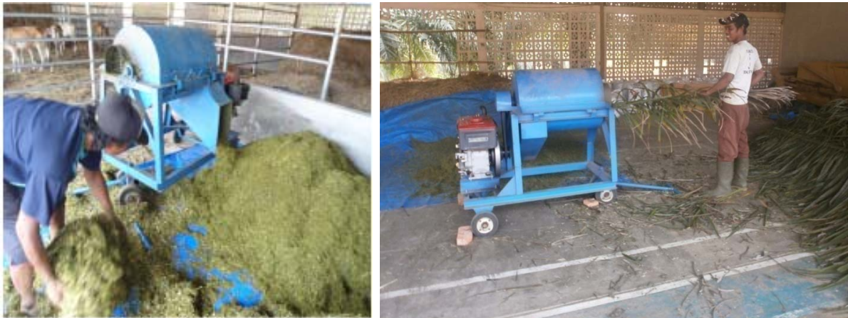
Gambar 2. Teknologi produksi pakan sapi menggunakan bahan berupa limbah kelapa sawit di KP Sitiung. BPTP Sumatera Barat (Bamualim et al. 2016).
