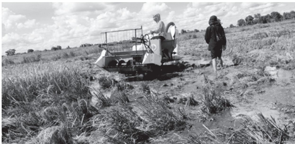
Gambar 2. Mesin mini combine harvester beroperasi pada lahan berair (rawa)
