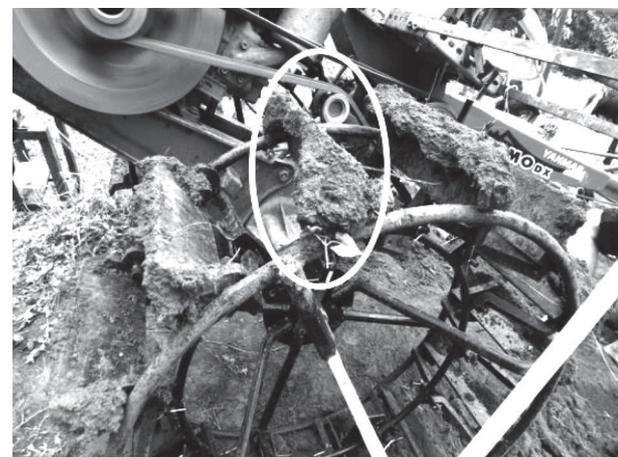
Gambar 10. Permasalahan pada pengujian roda besi bersirip *multi-angle*.
