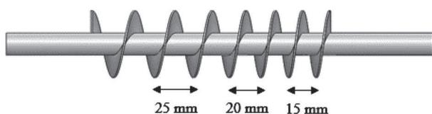
Gambar 3. Desain penjatah pupuk tipe auger dengan variable pitch.
