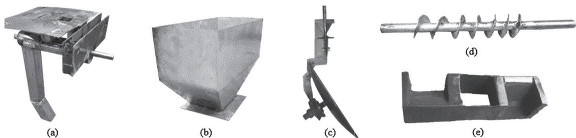
Gambar 8. (a) unit pemupuk; (b) *hopper* pupuk; (c) pembuka alur; (d) poros penjajah tipe *auger*; (e) pengarah pupuk (pengatur dosis).
