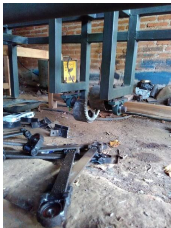
Gambar 7. Komponen Penggerak Kamprah (Penganam Benang)
