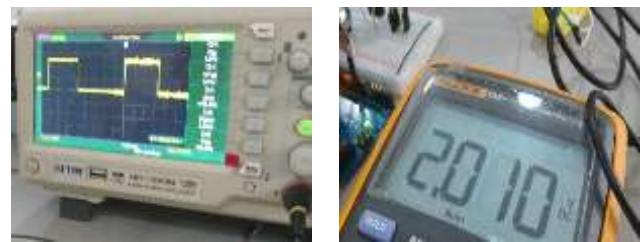
Gambar 9. Pengujian N-chanel Mosfet (>1.5 Volt)
