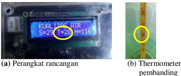
**Gambar 10.** Pengujian suhu pada air laut
