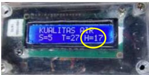
**Gambar 13.** Pengujian sensor kesadahan pada air tawar yang telah dipanaskan
