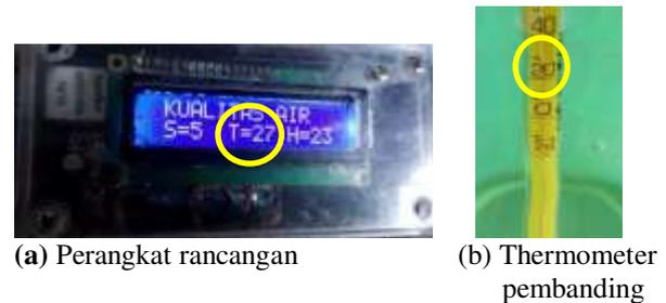
**Gambar 11.** Pengujian suhu pada air tawar
