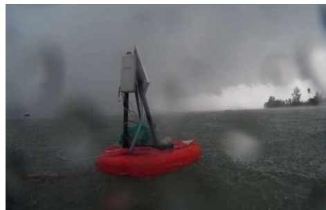
Gambar 8. Perangkat komunikasi data antara kamera bawah laut dengan user ( smartphone )
