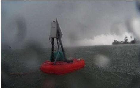
Gambar 5. Bagian kontrol pada pelampung
