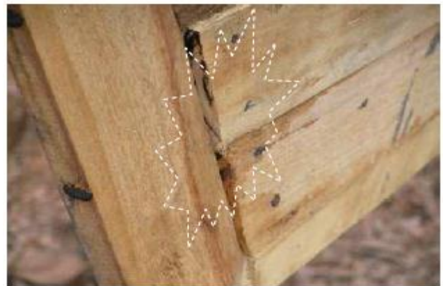
Gambar 6. Koneksi yang tidak sesuai bagian atas ke depan, akan menghasilkan ketebalan yang direncanakan dari papan yang tak terpuaskan, sehingga, dapat mengurangi kekuatan kapal sampai titik terlemah, di kapal papan.
