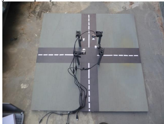
Gambar 4. Prototype Persimpangan Jalan
