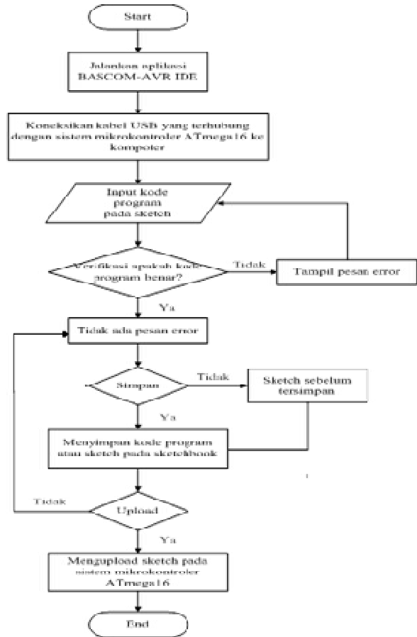
Gambar 10. Flowchart proses upload perintah pada mikrokontroler ATmega16
