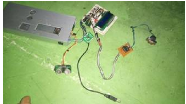
Gambar 10. Tampilan Keseluruhan Rangkaian Alarm Anti Maling Berbasis Mikrokontroler
