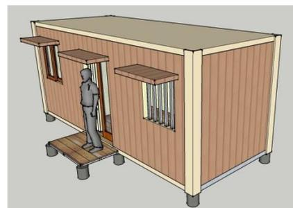
**Gambar 3. Penempatan Pondasi Pada Kontainer**
