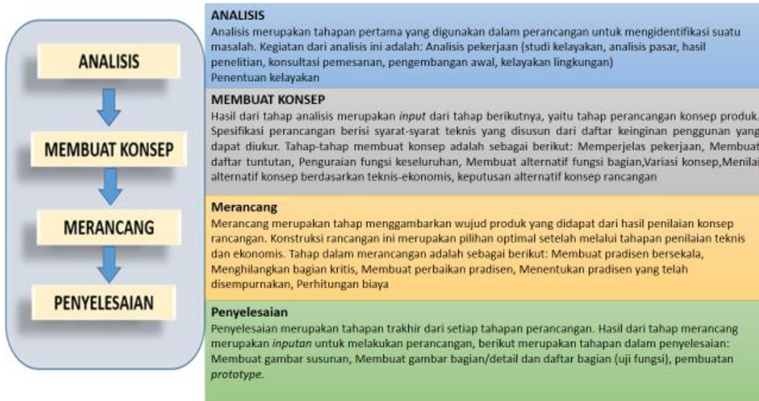
Gambar 2 Tahap-tahap perancangan yang dilakukan metode VDI 2222
