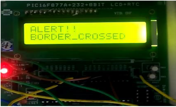
Fig: 10 Alert Message Displayed In LCD
