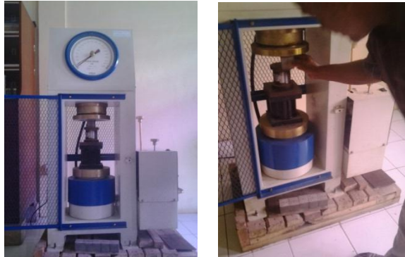
Gambar 3. Pengujian Kuat Tekan Mortar Beton
