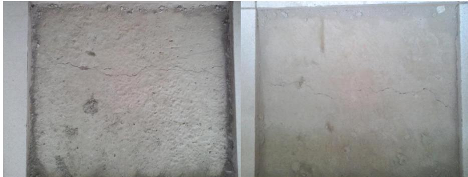
Gambar 3. Retakan pada Pelat yang Melendut
