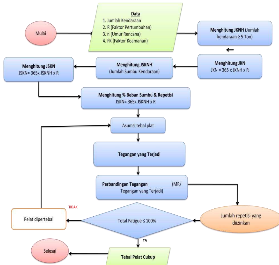
Gambar 1. Alur Perhitungan Tebal Pelat Beton
