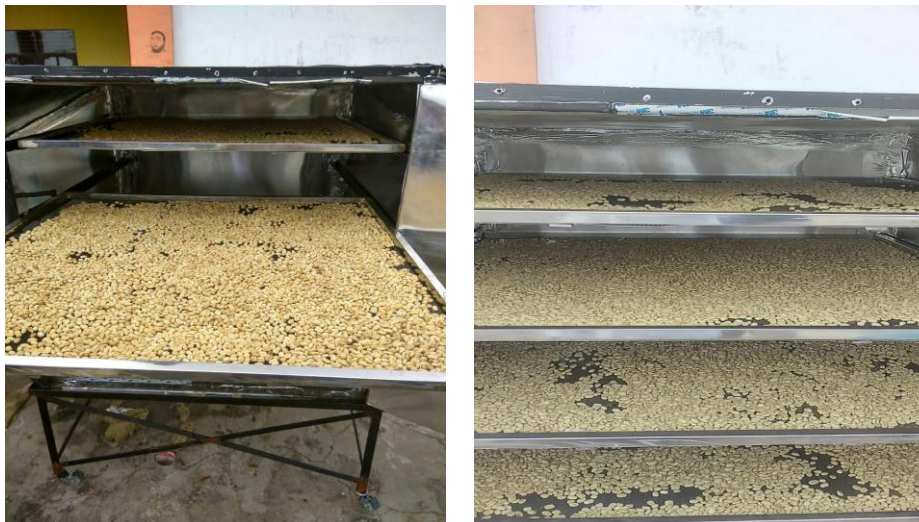
Gambar 4. Proses Ujicoba Pengeringan Biji Kopi pada Pengering Surya Tipe Kolektor Tabung Vakum
