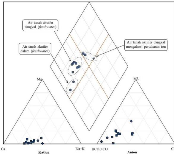
Gambar 3. Diagram Piper sampel air-tanah sekitar KNPJ.
